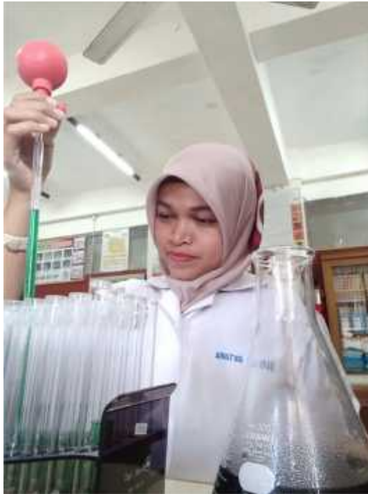
Gambar. Memindahkan medium BGLB kedalam tabung reaksi
